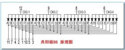
四位共阳极数码管,位控制端(1-4)给高电平使能相应的位,笔段控制端(A-G、DP)给低电平可点亮。
