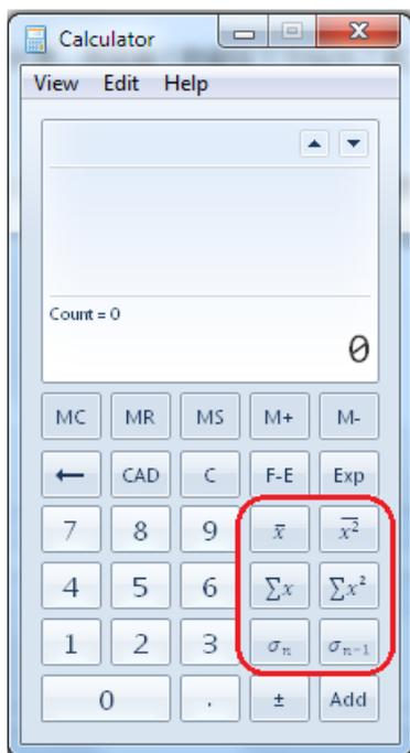
统计模式，这是一种完全不同的计算模式，你不再逐次的输入数据与操作符而得到一个结果，而是先输入一系列已知的数据，然后计算各种统计数据（注意，这里清除之前输入的一组数据的按钮为CAD）。支持的统计数据包括平均值、平方平均值，和，平方和，还有就是标准差(standard deviation)，标准差是方差的平方根，用来表示一组数据的离散程度。这里提供了两种标准差的计算方式：
