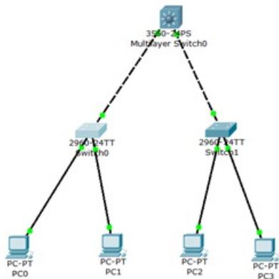
(2)按照实验线路连接图，在SW1和SW2上分别完成VLAN配置，并在VLAN中添加相应的端口成员，同时配置Trunk端口。同时测试各计算机之间是否可以相互ping通。
