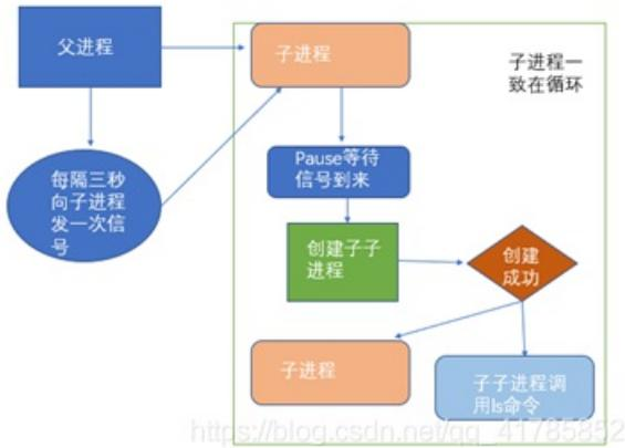
大体流程为:首先父进程创建子进程,父进程一直在执行循环体(每隔三秒向子进程发送一次信号)。对于子进程,如果创建成功,也一直在执行自己的循环体中(一直挂起等待信号唤醒,当被唤醒时,创建子子进程,子子进程用来执行调用函数(函数执行ls命令))。
