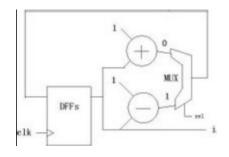
使用了一个加法器一个减法器,没比上面的电路省 (加上一个负数的补码确实就是减去一个数)
